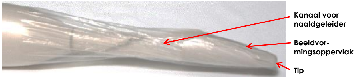
Afbeelding 12: EV29L-transducer met met gel gevulde huls
