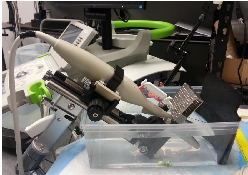
Afbeelding 41: Transducer en transperineale stepper in bak met water
