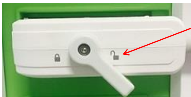
Afbeelding 29: Vergrendelknop transducerconnector in ontgrendelde stand
